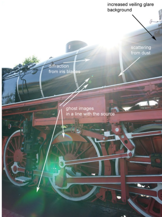
Abb. 1.11: Bild mit Falschlicht verschiedenen physikalischen Ursprungs: 1. Geisterbilder durch Reflektionen an Linsenflächen (Lichtkette durch Lichtquelle und Bildmitte), 2. An Staubkörnern oder anderem gestreutes Licht (außerhalb der optischen Symmetrieachse), 3. Streulichtuntergrund. Die (stark übersättigte) Lichtquelle erscheint bei abgeblendeter Irisblende „sternförmig“. (Die Welligkeit hängt mit der Lamellenzahl zusammen.) (Abbildung von Dr. Hubert Nasse.)
