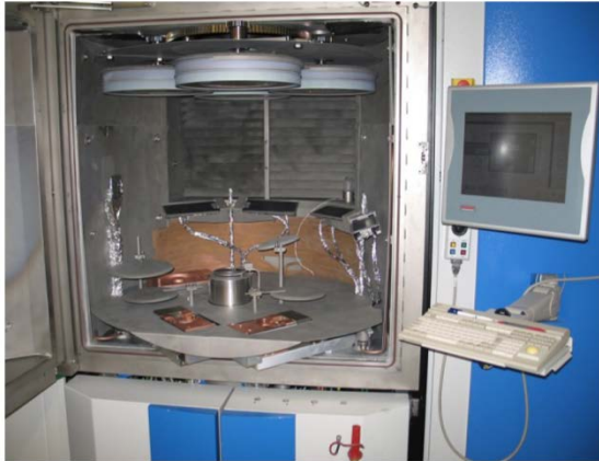
Abb. 2.36: Beschichtungsanlage mit Planetensystemgetriebe, die sehr homogen aufgetragene Beschichtungen ermöglicht.
