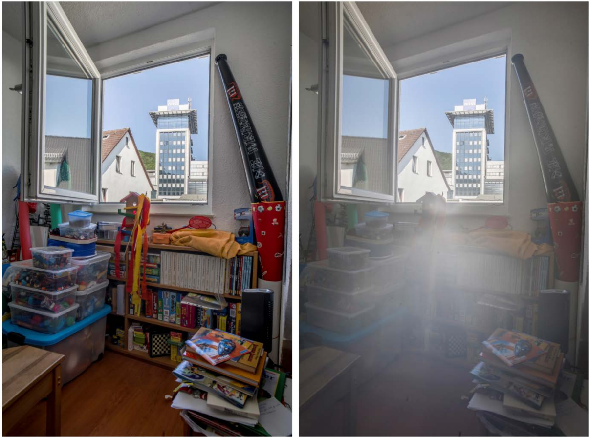
Abb. 1.25: Aus den Belichtungsreihen berechnete HDR-Bilder. Beim unbeschichteten Objektiv sinkt die Bildqualität des Innenbereichs dramatisch ab.
