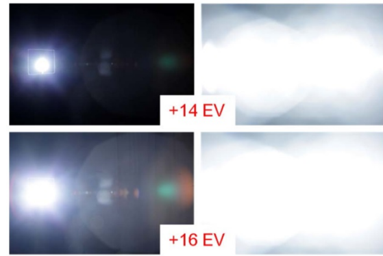
Abb. 1.13: Belichtungsserie des ZE 2,8/21mm T* im Vergleich zum nicht beschichteten Demonstrationsobjektiv 2,8/21mm bei Blende f/8 ausgehend von der im Helligkeitsumfang aufgelösten Glühlampe (links oben) jeweils in +2EV-Schritten länger belichtet.
