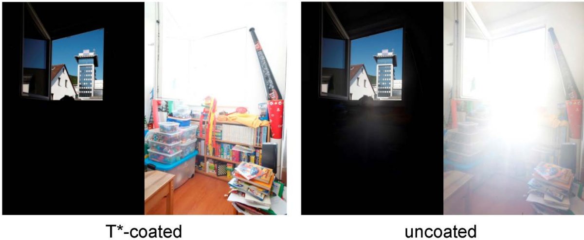
Abb. 1.23: Aufnahmen aus einem Raum an einem hellen Tag ins Freie mit dem Distagon 2,8/21 ZE (links) und mit dem unbeschichteten Demo-Objektiv (rechts) bei Blende f/8. Durch den begrenzten Dynamikbereich des Bildsensors sind Innen- und Außenbereich nicht gleichzeitig darstellbar. Beim unbeschichteten Objektiv dringt bei langer Belichtung viel Streulicht aus dem überbelichteten Bereich (Fenster) ein und überstrahlt große Bereiche des Innenraums.
