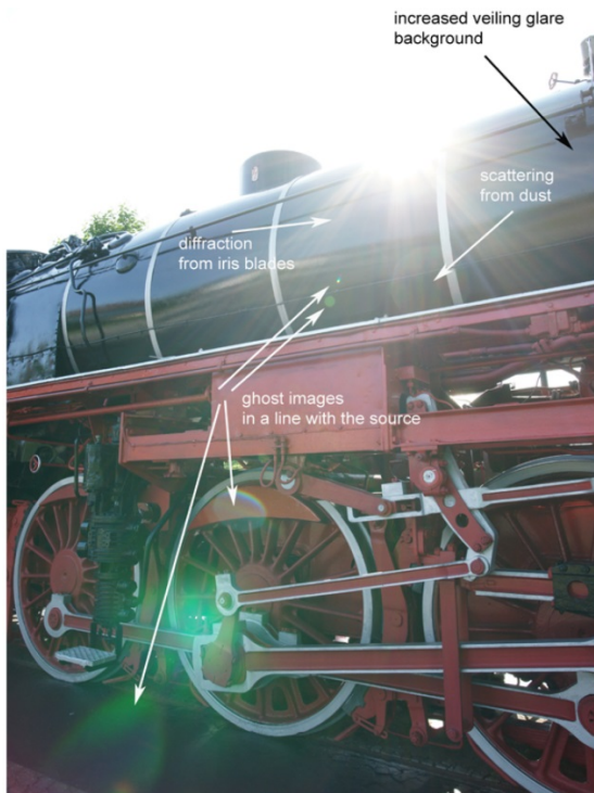
Abb. 1.11: Bild mit Falschlicht verschiedenen physikalischen Ursprungs: 1. Geisterbilder durch Reflektionen an Linsenflächen (Lichterkette durch Lichtquelle und Bildmitte), 2. An Staubkörnern oder anderem gestreutes Licht (außerhalb der optischen Symmetrieachse), 3. Streulichtuntergrund. Die (stark übersättigte) Lichtquelle erscheint bei abgeblendeter Irisblende „sternförmig“. (Die Welligkeit hängt mit der Lamellenzahl zusammen.) (Abbildung von Dr. Hubert Nasse.)
