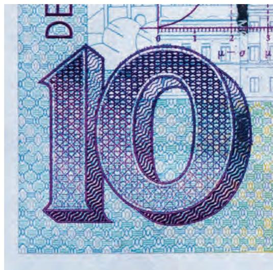
Fotografie eines Geldscheins, links eine Bildecke mit Objektiv Planar T\* 1,4/50 und 14mm hohem Zwischenring, rechts mit Makro-Planar T\* 2/100 ZF.2, beide Aufnahmen bei Blende 4.
