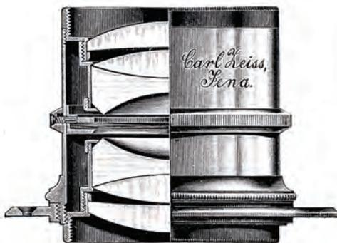
Das von Rudolph neu entwickelte Objektiv war streng symmetrisch aus sechs Linsen in vier Gruppen aufgebaut, mit zwei Meniskus-förmigen verkitteten Elementen vor und hinter der Blende (Meniskus heißt in der Optik eine Linse, bei der die Krümmungsmittelpunkte beider Flächen auf derselben Seite liegen).
