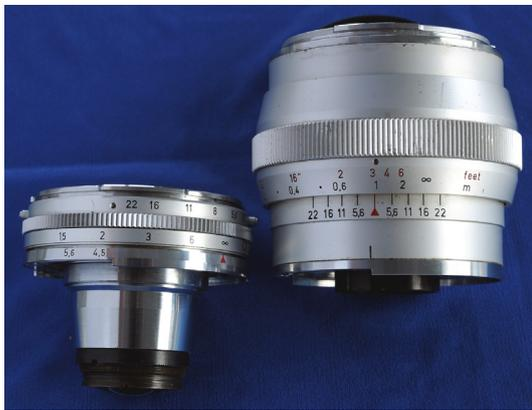
Dieser Vergleich eines Distagon 2,8/25 (rechts) mit einem Biogon 4,5/21 (links), beide in Fassung für die Contarex von Zeiss Ikon, verdeutlicht noch einmal die großen Unterschiede beider Bauprinzipien. Das Biogon ist fast gleich lang, verschwindet aber zum größten Teil in der Kamera; deren Spiegel hat dann natürlich Pause.
